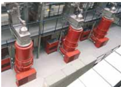
Planta granuladora para basura doméstica, para producir gránulos o "fluff"
