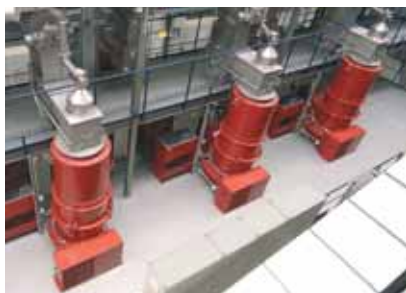
Planta granuladora para basura doméstica, para producir gránulos o "fluff"
