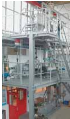
La planta piloto de SCHULE con planta de cocción continua para cereales, parboiling, alimentos, bulgur, etc.
