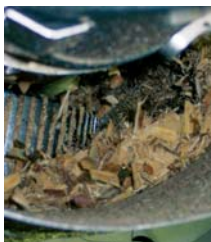
Molienda de recortes de madera entre rodillos y matriz
