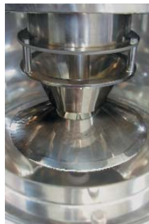
Cono distribuidor de producto del ROTOSPRAY®
